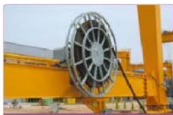
대형 크레인 전원공급용
